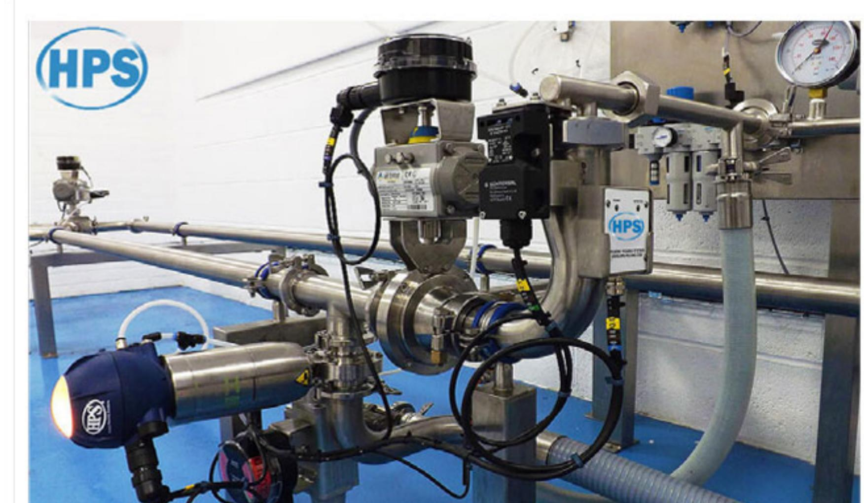
**Pigging System** เป็นระบบที่ช่วยในการนำส่งผลิตภัณฑ์ของเหลวที่ติดค้างอยู่ในระบบการพลิตให้ไปยังปลายทางได้มากกว่า 90% เช่นส่งผลโดยตรงต่อมูลค่าการสูญเสียที่ลดลงและปริมาณผลิตภัณฑ์ที่เพิ่มขึ้น ซึ่งในโรงงานและพื้นที่อุตสาหกรรมที่ต้องการลดต้นทุนและการใช้พลังงาน ระบบ Pigging System กันอย่างกว้างขวาง เพราะประโยชน์ทางด้านการเก็บกู้ผลิตภัณฑ์ที่ติดค้างตามแนวท่อ การลดปริมาณและจำนวนครั้งของการทำความสะอาด ความประหยัดพลังงานและทรัพยากร และที่สำคัญที่สุดคือการเพิ่มผลกำไรในระยะยาว
